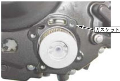
○オイルフィルターアダプターのOリングとスプリングが脱落しないように注意しながら、車両に取り付けます。
