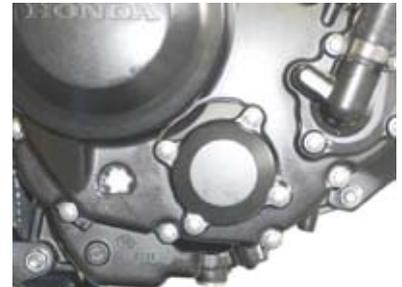
○キット付属のオイルフィルターアダプターに、Oリング 55mm と純正のオイルフィルタースプリングを取り付けます。
