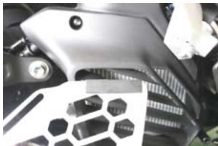
○①ラジエターコアガードを④ボタンヘッドソケットスクリュー 6x55 と⑤ボタンヘッドソケットスクリュー 6x80 を使用し、規定トルクにて締め付けます。
