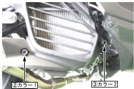
○①ラジエターコアガードを純正ラジエターガードにあてがいながら、写真を参考に ⑥ラバープレートをカットし、①ラジエターコアガードに貼り付けます。車両の個体差により、2枚重ねて貼り付ける場合もあります。純正ラジエターガードと①ラジエターコアガードの間に隙間がない様に確認しながら、⑥ラバープレートをご使用下さい。
