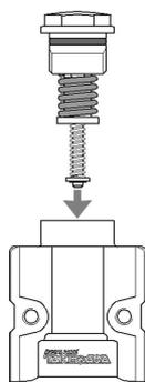
2. フィッティングアダプター#6にアルミシーリングワッシャ10mmを通し、サーモユニットハウジングに取り付けます。
