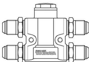
3. 車両のオイルラインに割り込ませるように取り付けます。本キットは、車両に取り付ける部位やエンジン・オイルクーラー仕様に合わせて、エンジン側/オイルクーラー側を配管する事が出来ます。下図を参照し、ご使用になる車両や仕様に合わせて取り付け作業を行って下さい。
