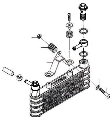
5. バンジョーボルトにシーリングワッシャ、バンジョー、シーリングワッシャの順で通しオイルクーラーCOMP.側のシーリングワッシャがオイルクーラーヘッダー(六角部分)の凹部からずれないように取り付けて仮締めします。シーリングワッシャがずれた状態でバンジョーボルトを締め付けた場合、オイル漏れの原因となります。
