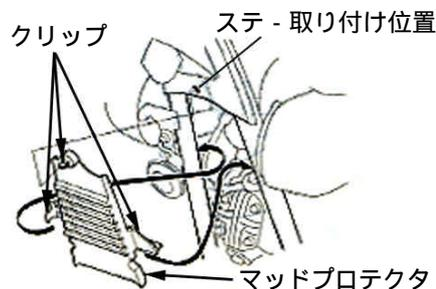
3. オイルクーラーステ - にマウントラバーを取り付け、カラーを差し込みます。ボタンヘッドスクリュー6×20を使用し、オイルクーラーステ - をオイルクーラー本体に取り付け指定トルクで締め付けます。
