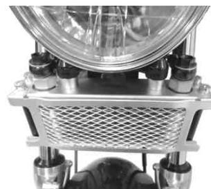
11. オイルクーラー、オイルクーラーユニットのそれぞれのバンジョーの向きを調整し、バンジョーボルトを締め付けます。
