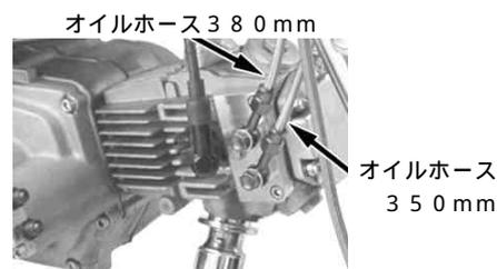
10. オイルホースを他の部分と著しく干渉しないように注意しながらフレームのヘッドパイプの左側から取り回し、オイルホース380mmをオイルクーラーの右側に350mmを左側に取り付け、締め付けます。
