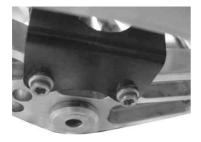
6 . オイルクーラーバンジョーをシーリングワッシャ 1 4 mm 2 枚で挟み、オイルクーラーにバンジョーボルトで仮締めします。 下側シーリングワッシャは、オイルクーラーヘッダー(6 角部分)の 凹に合わせて取り付けて下さい。ワッシャがズレたまま締め付けますと、オイルが漏れますのでご注意下さい。
