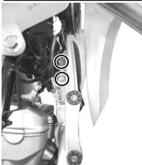
取り付けしたオイルクーラスターにボタンヘッドソケットスクリュー 6 × 20 でオイルクーラーを取り付けます。
