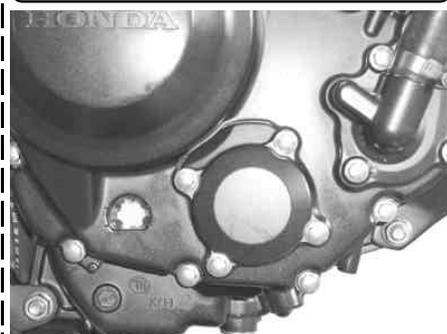
キット付属のオイルフィルターアダプターに、Oリング 5 5 mm と純正のオイルフィルタースプリングを取り付けます。
