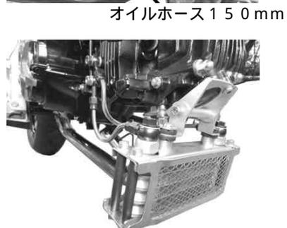
取り回しが完了すればバンジョーボルト、オイルホースのフィッティングを締め付けます。
