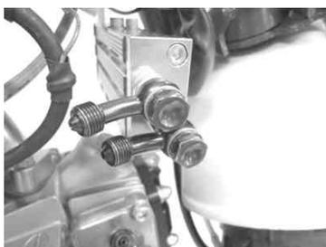
9. バンジョーに オイルホースを取り付け、そのホースのもう一方をオイルクーラーユニットCOMP .に取り付けます。バンジョーの取り付け角度、オイルホースの取り回しが決まれば、バンジョーボルト、フィッティングを規定トルクで締め付けます。
