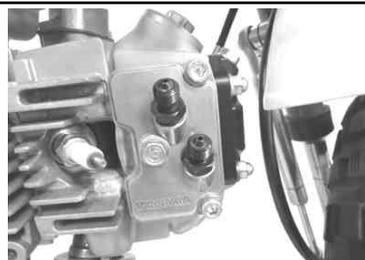
6. オイルクーラーステーを オイルクーラーCOMP に ソケットキャップスクリュー5×10と プレーンワッシャ5mmを使用して取り付け、規定トルクで締め付けます。
