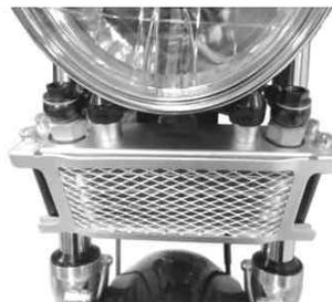
11. オイルホースの取り回し、バンジョーの取り付け角度が決まったら、バンジョーボルト、オイルホースのフィッティングを指定トルクで締め付けます。
