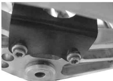
8. オイルクーラーバンジョーをシーリングワッシャ14mm2枚で挟み、オイルクーラーにバンジョーボルトで仮締めします。
