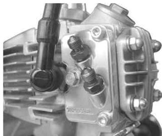
4. オイルクーラーブラケットにクッションラバーを取り付け、クッションラバーにカラー7.8×6.2×1.2を取り付けます。
