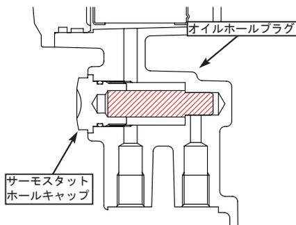
▲注意：クラッチカバーからクーラーホースを外し、プラグボルトを取り付けた場合は、(購入時の状態)必ずオイルホールプラグ若しくはサーモユニットを取り外して下さい。
