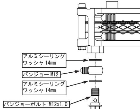
・クラッチカバーのオイル取出口に取り付けられているプラグボルトを取り外します。
