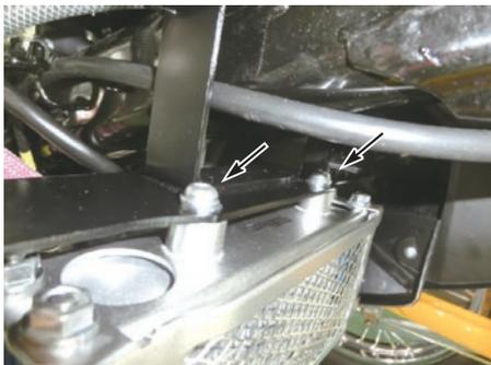
・オイルクーラーにバンジョー M12 を、アルミシーリングワッシャ 14mm 2 枚で挟み込み、バンジョーボルト M12x1.0 で取り付けます。
