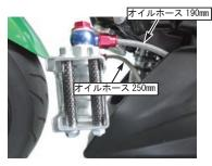
○取り回しが完了すればバンジョーボルト、オイ ルホースのフィッティングを締め付けます。 ※バンジョーボルト M12 の締め付けは、オイル クーラーヘッダー(6角部分)に必ずスパナ等
