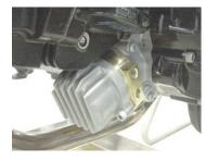
○バンジョーボルト M10 にシーリングワッシャ 10mm、バンジョー 10mm、シーリングワッシャ 10mm の順で通し、オイルフィルターアダプターに取り付けて仮締めします。
