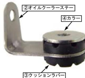
○⑤ボタンヘッドスクリュー 6x20 を用いてオイルクーラーに先程組み付けた②オイルクーラーステーを組み付けます。
