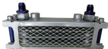
5. オイルクーラーステーにクッションラバーを取り付け、クッションラバーにカラーを取り付けます。
