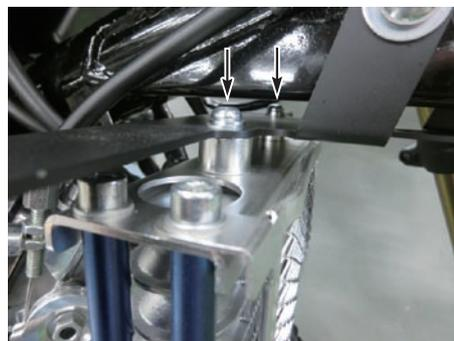
・オイルクーラーにバンジョー 14mm を、アルミシーリングワッシャ 14mm 2枚で挟み込み、バンジョーボルト M12x1.0 で取り付けます。
