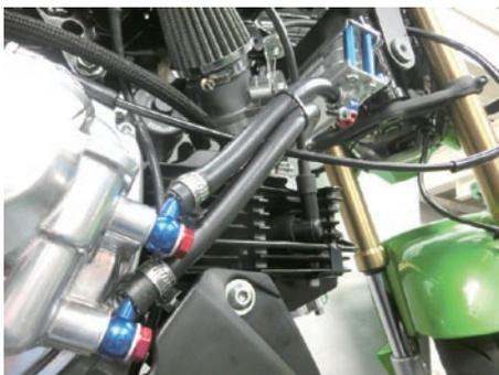
・取り回しが完了すればバンジョーボルトを締め付けます。
