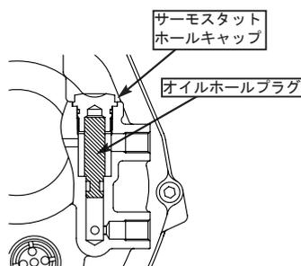
▲注意：クラッチカバーからクーラーホースを外し、プラグボルトを取り付けた場合は、（購入時の状態）必ずオイルホールプラグ若しくはサーモユニットを取り外して下さい。
