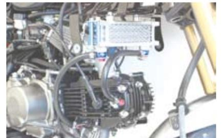
・取り回しが完了すれば②③バンジョーボルトを締め付けます。
