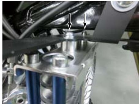
・オイルクーラーに④バンジョー 14mm を⑨アルミシーリングワッシャ 14mm 2枚で挟み込み、②バンジョーボルト M12x1.0 で取り付けます。
