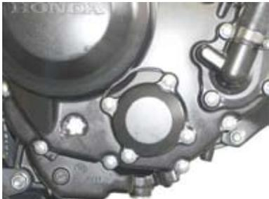
○キット付属の⑳オイルフィルターアダプターに、㉖Oリング55mmと純正のオイルフィルタースプリングを取り付けます。
