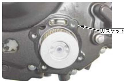
○㉖オイルフィルターアダプターの㉖Oリング55mmとスプリングが脱落しないように注意しながら、車両に取り付けます。下図中、黒矢印部分のボルトは純正のオイルフィルターアダプターを固定していたフランジボルト6x25を再使用し、白矢印部分は、キット付属の㉗フランジボルト6x30を使用します。
