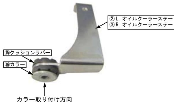
○オイルクーラープレートサイドのキャップボルトとフランジナットを上下反対にマウントします。
