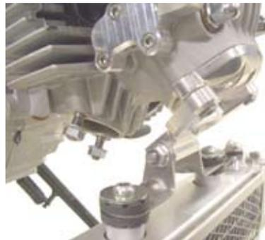
○クラッチカバー下にオイル受け皿を設け、写真の位置についているボルト2本を取り外します。
