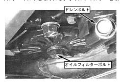
〇オイルフィルターボルトの 0 リングを® 0 リング 16mm に交換する。
