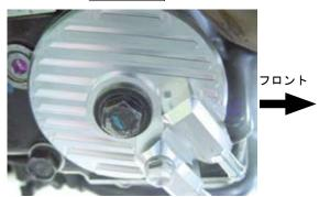
○図を参考にし、⑤オイルフィルターキャップに⑥オイルプラグボルト、 ⑦ストレートユニオン M10、⑧アルミシーリングワッシャ 10mm を取り 付ける。
