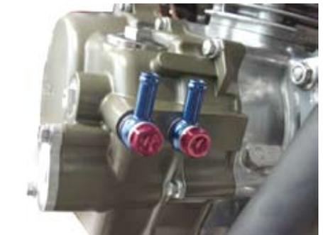
○キット付属の⑤オイルホース 1500mm を写真を参考にし、オイルクーラー側の②バンジョー M12、カバー側の⑬バンジョー 10mm（ストレート）に差し込み⑥ホースクランプで締め付けます。
