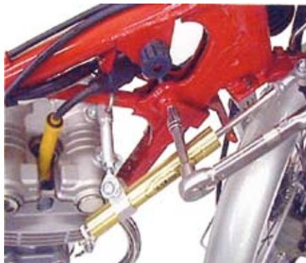
○①コンパクトクール（以下オイルクーラー）を⑦オイルクーラーステータASSY. に⑫プレーンワッシャ 6mm と⑨フランジボルト 6x10 で取り付け、規定トルクで締め付けます。
