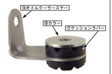
○⑤ボタンヘッドソケットスクリュー 6x20 を 用いて①コンパクトクール(以下オイルクー ラー)⑭にオイルクーラーステーを取り付け、 締め付けます。
