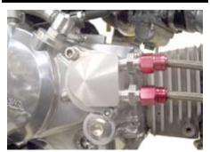
○③オイルホース 150mm をオイルクーラーの 右側に、②オイルホース 390mm を左側に取り 付け、締め付けます。②オイルホース 390mm を⑨結束バンド 150mm を用いて固定します。
