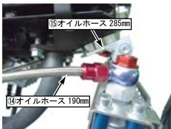
○取り回しが完了すればバンジョーボルト、オイルホースのフィッティングを締め付けます。
