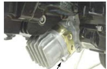
○⑩バンジョーボルト A M10x1.25 に⑦アルミシーリングワッシャ 10mm、⑫バンジョー (ストレート)、⑦アルミシーリングワッシャ 10mm の順で通し、⑳オイルフィルターアダプターに取り付けて仮締めします。
