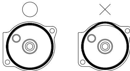
・クランクケースのオイル通路 (写真) にオイルを薄く塗布し、⑳オイルフィルターアダプターを取り付けます。
