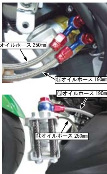
○取り回しが完了すればバンジョーボルト、オイルホースのフィッティングを締め付けます。
