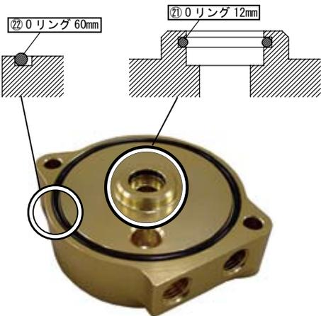
※⑳Oリング 60mmを取り付ける際、溝の外側にOリングがはみ出さないように注意して下さい。
