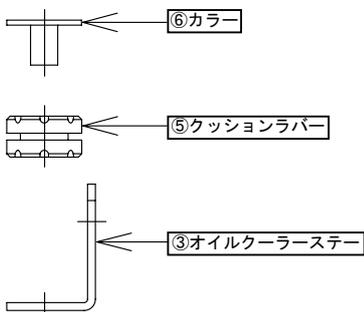
○⑮ボタンヘッドソケットスクリュー 6x20 を用いてオイルクーラーに先程組み付けた③オイルクーラーステーを組み付けます。
