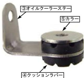
○⑭ボタンヘッドソケットスクリュー 6x20 を用いてオイルクーラーに先程組み付けた③オイルクーラーステーを組み付けます。
