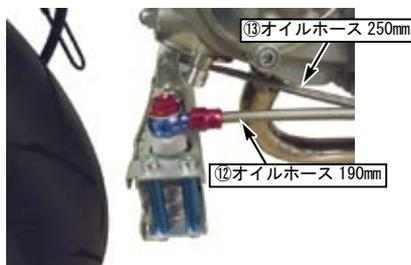
○取り回しが完了すればバンジョーボルト、オイルホースのフィッティングを締め付けます。
