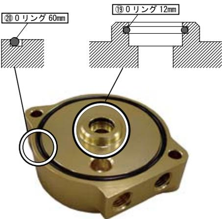
※Oリング 60mmを取り付ける際、溝の外側にOリングがはみ出さないように注意して下さい。
