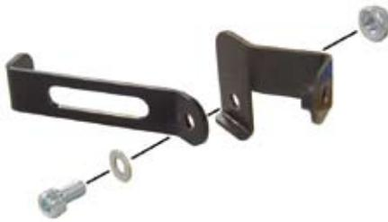
○次に、⑯ソケットキャップスクリュー 6x12に、⑪ブレンワッシャ 6mm、先程組み立てた②オイルクーラースター2、①オイルクーラースター1の穴を通してから、⑱フランジナット 6mmで仮付けします。
