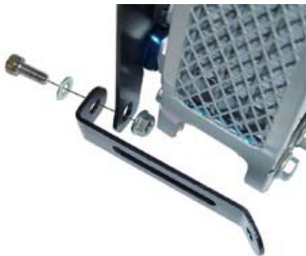
○L. シュラウドの、燃料タンク側のスクリューを仮止めしてから、先程仮止めた②オイルクーラースター2の位置を調整し、L. シュラウドに純正スクリューを通して、②オイルクーラースター2の裏から、⑱フランジナット 6mmで固定します。
