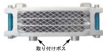
○⑪オイルクーラーステーに①コンパクトツール(以下オイルクーラー)を⑭ボタンヘッドソケットスクリュー6x10、⑮スプリングワッシャ6mm、⑯プレーンワッシャ6mmで取り付け締め付けます。
