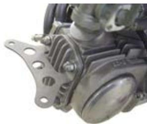
○⑦オイルクーラーユニット COMP. に⑧Oリング 31mm、⑨Oリング 15mmを取り付け⑩ソケットキャップスクリュー6x20で締め付けます。
