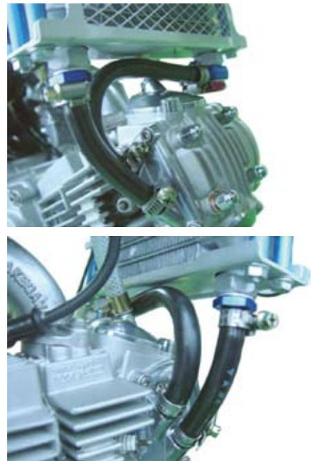
○⑨オイルホース1000mmを適当な寸法に切断し、⑥オイルクーラーユニット COMP. と②バンジョー M12/④アダプター（ストレート）に差し込み、⑩ホースクランプを締め付けます。
