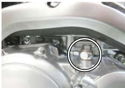
2. 車体跨ってL側のシリンダー側面にオイルデリバリパイプを固定しているバンジョーを緩めます。2箇所のバンジョーを緩めればオイルデリバリパイプを取り外します。
