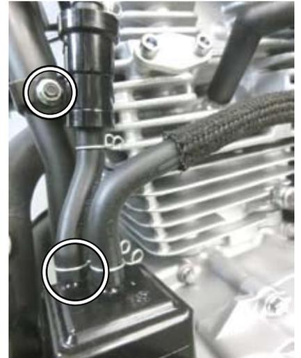
■ダウンチューブボルト2本にオイルクーラーステーを通しダウンチューブフレームに取り付けます。仮でナットを固定します。
