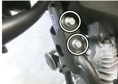
■オイルクーラーステーにクッションラバーを取り付け、クッションラバーにカラーを取り付けます。
