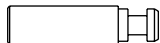
オイルホールプラグ (00-02-0391) ※サーモスタットユニットを装着しない場合は スペシャルクラッチカバーに装着して下さい。
