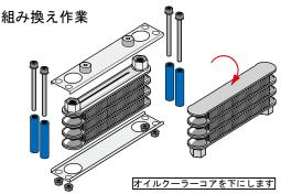
組み替え方は、オイルクーラー本体の両サイドにあるナットを外し、ソケットキャップスクリュー、カラーパイプ、オイルクーラープレートを取り外します。オイルクーラー本体を上下逆にし、オイルクーラープレートで挟み、ソケットキャップスクリューとナットで締めこみます。
