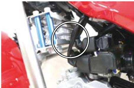
■バンジョー、バンジョーボルトの組み付け
