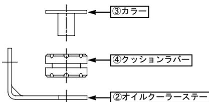
■⑥ボタンヘッドソケットスクリュー 6x20 を用いてオイルクーラーに先程組み付けたオイルクーラーステーを組み付けます。
