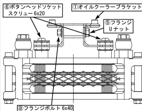
※締め付け後、必ずフロントフォークがフルストローク時オイルクーラーに接触しないかどうかを確認して下さい。
