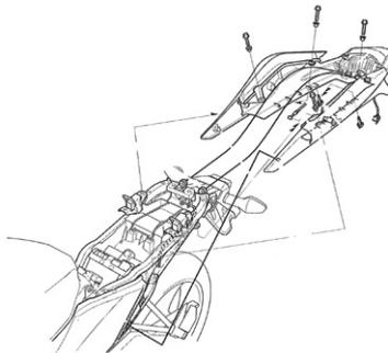
○下図を参照し、②ヘルメットホルダーステー COMP. に④ラバープレートを貼り付けます。
