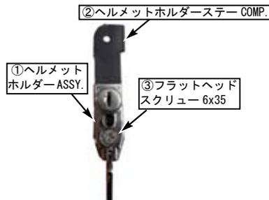
○L. サイドカバーの1番後ろのソケットボルトを取り外し、サイドカバーとフレームの間に②ヘルメットホルダーステー COMP. を取り付けソケットボルトと締め付けます。
