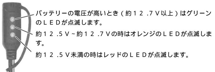
何も点滅しない場合は、+ - を逆に接続しているか、破損しているバッテリーである事が考えられます。
