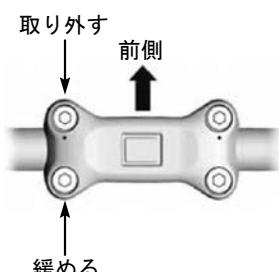
○純正ハンドルアッパーホルダー、弊社製ハンドルクランプアッパーホルダーをご使用中の場合、②カラー (8.2x13.8x15.5)を入れ、①シガーソケットステーをセットして④ボタンヘッドソケットスクリュー8x50を締め付けに使用します。
