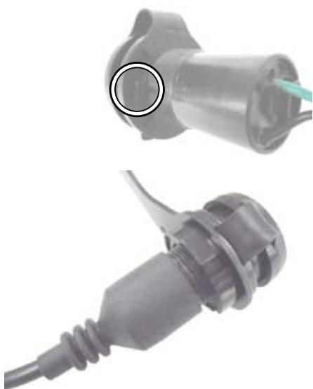
○車両進行方向左側上下の純正ソケットボルトキャップと純正ソケットボルトを外します。
