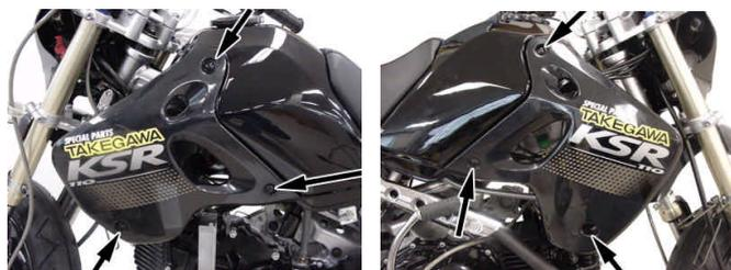
2. 左タンク下車体側面のスピードメーター用6極カブラ(黒)を取り外し、エアクリナーボックス固定ボルト2本とハンドルロックキーシリンダー後方のコードクランプ固定ボルトを外して下さい。
