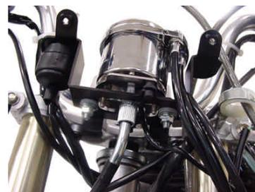
11. メーター電源用配線の茶コードと、パルス入力配線を接続し、イグニッションコイル付近まで取り回して下さい。余ったパルス入力配線は、ハンドルをきった時に余裕がある長さで切断して下さい。
