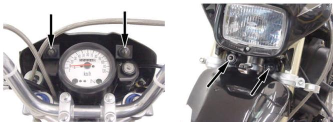
4. スピードメーターケーブル、メーター固定ナット及びワッシャを取り外し、STDスピードメーターをフレームより外して下さい。
