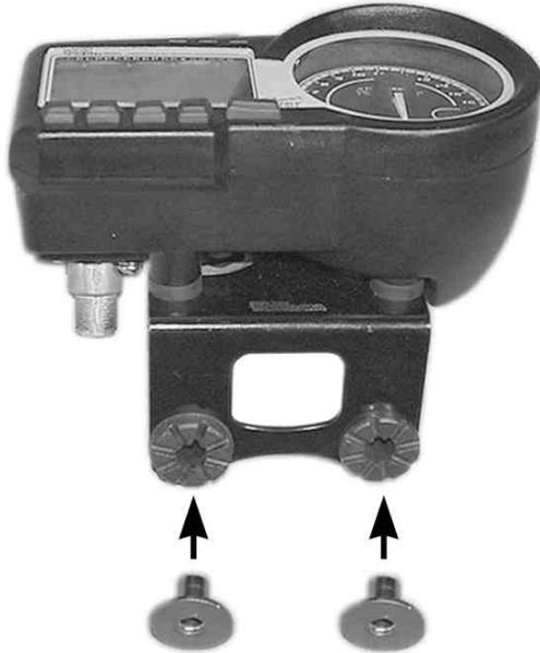
2. 本キットに、先ほど組立てたスーパーマルチLCDメーター及びステ - を組み付けます。
