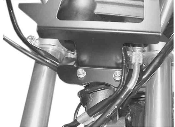
4. イグニッションスイッチをステ - 取り付け穴に差し込み、ステ - の凹部と、スイッチの凸部を合わせ、キット付属のイグニッションスイッチカバーで固定します。
