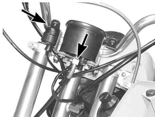
6. トップブリッジ裏のメーターステ - 固定スクリューを2本取り外し、メーターステ - を取り外します。
