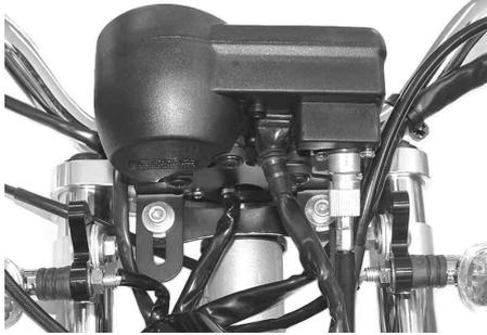
3. 別紙配線図を参照し、車両側ハーネスとハンドルスイッチを接続しているカプラー（黒色・6ピン）を外して、本キットのメーターサブコードを間に取り付け、ニュートラルランプが付いていたカプラー（茶色・2ピン）に、メーターサブコード2を取り付けます。
