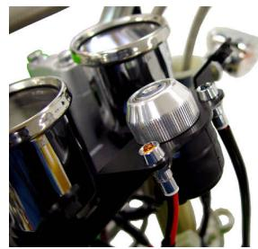
13. イグニッションスイッチのコードを車体左側から取り回しし、 車体側 2 極カプラ（白）を車体左側に移動させ接続し、 項目（3）で 外したコードクランプ及びエアクリーナーボックスを取り付けて下さい。
