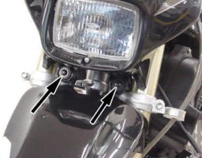
4. タンク右下側のイグニッションスイッチ用2極カプラ(白)の接続を外し、イグニッションスイッチカバーを取り外し、STDメーターステーよりイグニッションスイッチを取り外して下さい。
