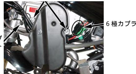
2. フロントカウル固定ボルト各4本を外し、フロントカウルのヘッドライトユニットの6極カプラ(白)の接続を外し、フロントカウルを取り外して下さい。
