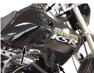
3. タンク左下車体側面のスピードメーター用6極カプラ(黒)を取り外し、エアクリーナーボックス固定ボルト2本と、ハンドルロックキーシリンダー後方のコードクランプ固定ボルトを外して下さい。
