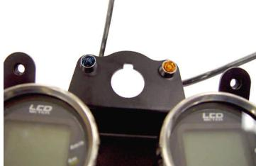
9. メーターサブコードを S T D メーターコードと同じ取り回しで フレームに沿わせ、 タンク左下車体側面のスピードメーター用 6 極 カプラ（黒）と接続して下さい。
