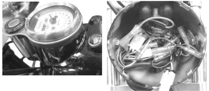
12. ヘッドライトケース内の配線類をヘッドライトユニットが入りやすい様にセットし、ヘッドライトレンズのTOPマークを上向きにセットし、ヘッドライトソケットにコネクタを接続してヘッドライトユニットをスクリュー2本にて取り付けて下さい。
