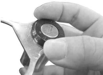
10. スピードメーターにステータCOMP.、スピードメータークッションの順に取り付けます。
