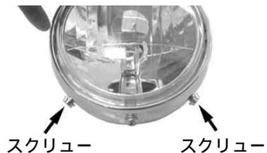
ハロゲンバルブは指で直接ガラス部分を触らないで下さい。
