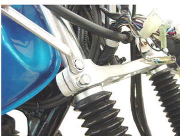
6. ヘッドライトステーを項目5で取り外した純正ボルトにて、アンダーブラケットに取り付けます。
