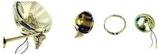
8. ヘッドライトケースをヘッドライトステーに付属のワッシャ、スプリングワッシャ、ナットの順で仮止めます。
