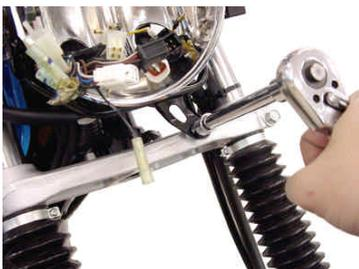
4. ナット及び純正ボルトにてメーターASSYを元の位置に取り付けます。
