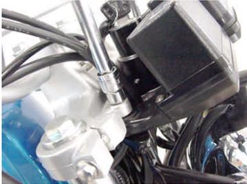
3. ヘッドライトステーをアンダーブラケットに固定してあるボルト1本を外し、ヘッドライトステーを車体より取り外します。
