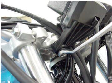
5. アンダーブラケットのフロントフォーク固定ボルト左右各2個を外します。
