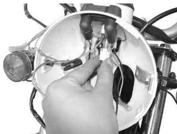
6. 純正ヘッドライトケース両サイドのボルト2本を取り外し、ヘッドライトケースを取り外します。ここで取り外した純正のボルト2本は再使用しますので、紛失しない様に保管しておいて下さい。
