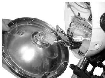
3. 純正ヘッドライトソケットに接続されている3Pカプラーを外し、ヘッドライトユニットを車両から取り外します。
