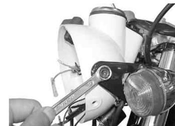
7. 取り外した逆の手順で、本キットのヘッドライトケースを取り付け、純正ボルトと、キット付属のワッシャ8mm及びフランジナット8mmで仮止めします。この時、ご使用になるウインカーやメーター類の仕様に合わせ、必要に応じてキット付属のアースコード8mmを、ヘッドライトケースを固定しているフランジナット8mmで共締めして下さい。
