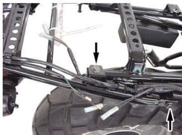
4. テールランプステーCOMPにテールランプASSYを付属のワッシャ、ナットにて取り付け、固定して下さい。
