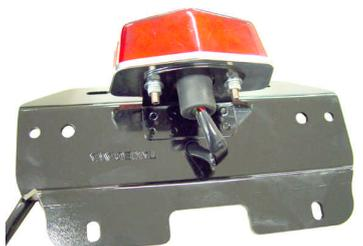
5. 純正ボルト4本にて テールランプステーCOMPをフレームに固定して下さい。
