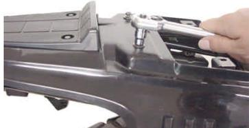
3. リアウinker及び、テールランプの配線を外し、リアフレーム上部のボルト2本、側面左右のボルト各1本を外し、リアフレームを取り外して下さい。
