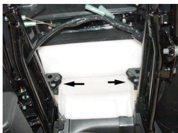
2. リアフェンダー上部のボルト2本、裏側のボルト2本を外し、リアフェンダーを取り外して下さい。
