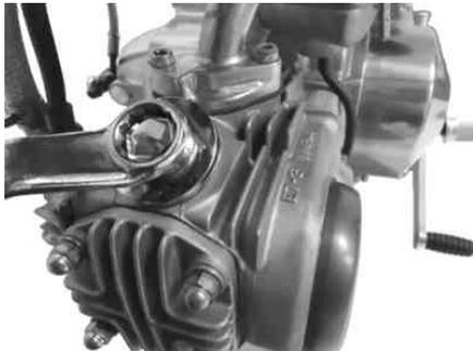
キット内のタペットキャップ及びプリーザーキャップにOリングを取り付け、Oリング部に少量のエンジンオイルを塗布しエキゾースト側にタペットキャップ、インテーク側にプリーザーキャップを取り付けます。
