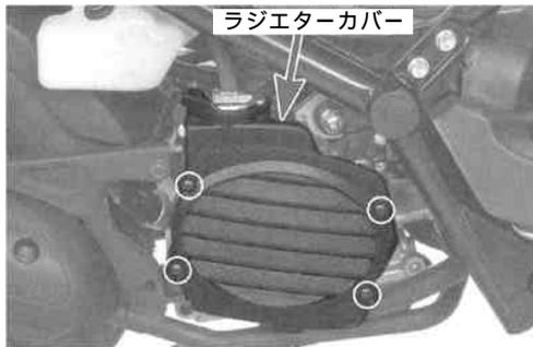
2. ラジエーターコアガードを、タッピングスクリュー4×16で取り付けます。
