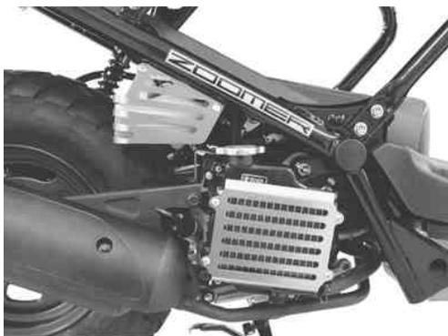
3. ラジエーターに向かって左上のスクリューを外して、キャップストッパーステーをラジエーターキャップに引っ掛け、外したスクリューで共締めします。
