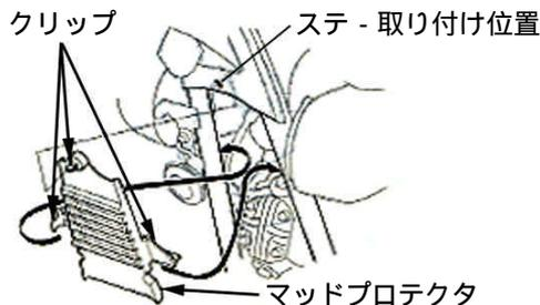
2. オイルクーラーステ - にマウントラバーを取り付け、カラーを差し込みます。ボタンヘッドスクリューを使用し、オイルクーラーステ - をオイルクーラー本体に取り付け指定トルクで締め付けます。
