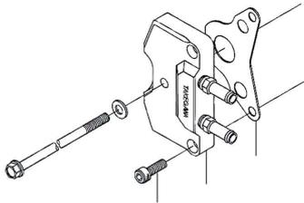
3. シリンダーヘッドL ガスケット面を脱脂し、新品のガスケットを使用してL シリンダーヘッドサイドカバーの位置を合わせてシリンダーヘッドに取り付けます。
