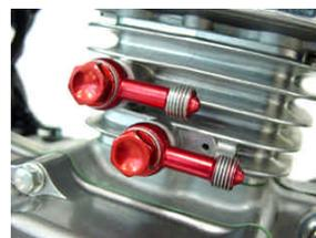
バンジョーボルトは2種類あります。先端の長いタイプのバンジョーボルトBを上側のオイルライン取出し穴に使用します。(オイルライン取出し穴は下側が吐出用です。)
