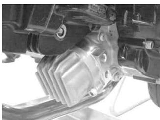
6. アダプターにシーリングワッシャを通し、オイルクーラーCOMP.に取り付け、規定トルクで締め付けます。
