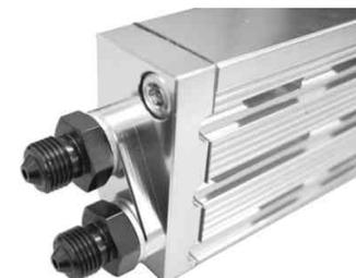
7. ソケットキャップスクリュー5×1.0とブレンワッシャ5mmを使用してオイルクーラーブラケットをオイルクーラーCOMP.に取り付け、規定トルクで締め付けます。
