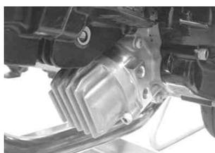
6. バンジョーボルトに シーリングワッシャ10mm、バンジョー、シーリングワッシャ10mmの順で通し、オイルフィルターアダプターに取り付けて仮締めします。
