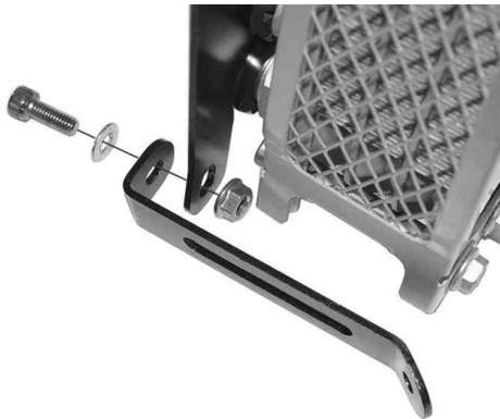
3. L. シュラウドの、燃料タンク側のスクリーンを仮止めてから、先程仮止めたオイルクーラースター 2 の位置を調整し、L. シュラウドに純正スクリーンを通して、オイルクーラースター 2 の裏から、フランジナット 6 mm で固定します。
