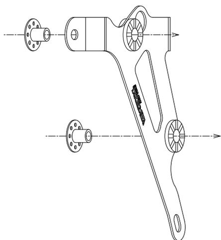
3. オイルクーラーステーの裏面(クッションカラー側)より、ソケットキャップスクリュー6×2.5を通し、アルミカラーを挟んでから、オイルクーラーComp.を取り付けます。
