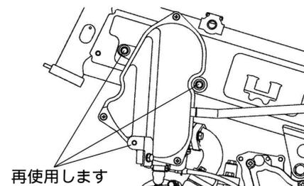
3. 純正エアクリーナーボックスを固定しているスクリーンを用いて、オイルクーラースターを、車両に取り付けます。
